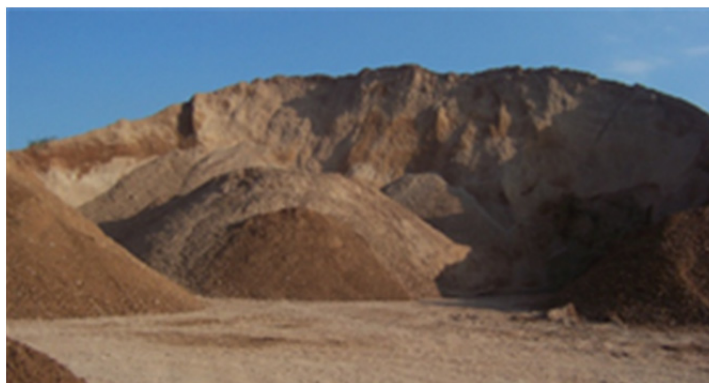
Figura 2. Acopio de AGR fracción 0-40 mm para uso en rellenos tipo terraplén.
